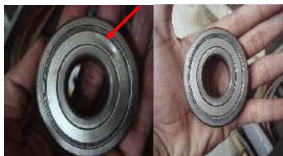
Gambar 3. Kondisi bearing yang rusak dan yang baru
