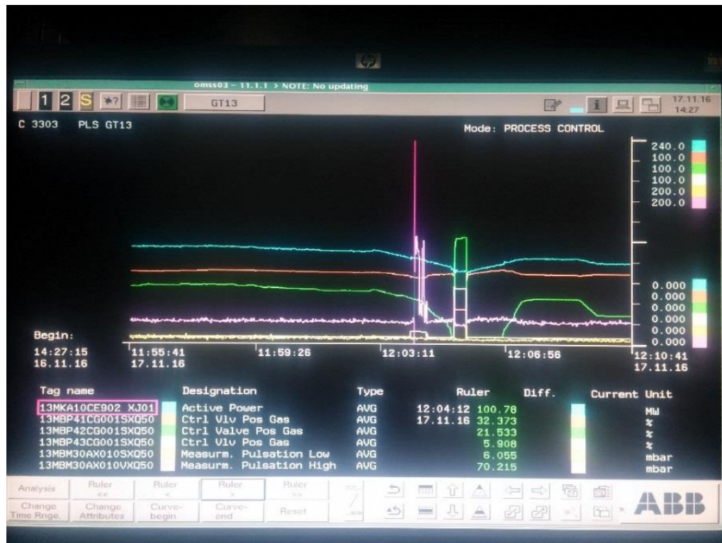
Gambar.3 Trending HMI Saat Gangguan Turbin Gas Karena Prefilling
