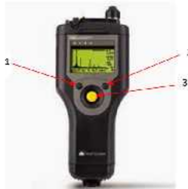
Keterangan : 1. Tombol Knob Kiri 2. Tombol Knob Kanan 3. Joystick dan Tombol Enter Gambar 3. Vibscanner
