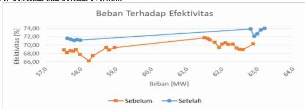
Gambar. 3.7 Grafik Beban Terhadap Efektivitas Sebelum Dan Setelah Overhaul
