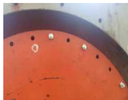
Gambar 12. Pemasangan pemberat hasil trial mass ke-2 (titik 30^\circ )
