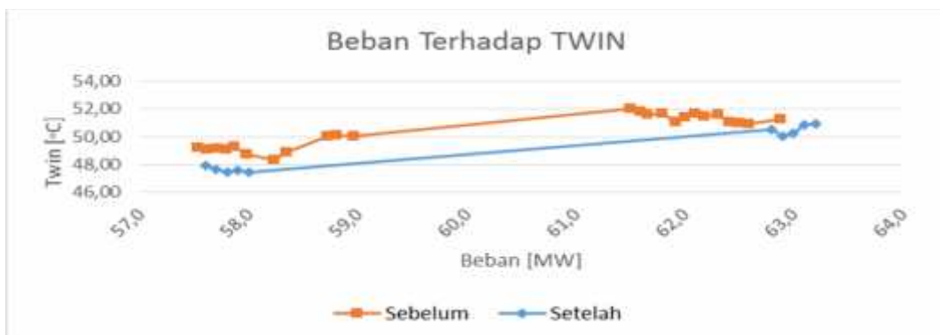
Gambar. 3.10 Grafik Beban Terhadap TWIN Sebelum Dan Setelah Overhaul
