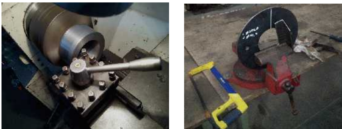
Gambar 6.(a). Proses pembubutan profil hub setelah proses penggerindaan dan 6.(b). Proses pemotongan profil Piringan menjadi dua bagian setelah dibubut
