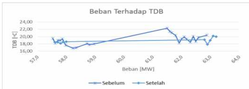
Gambar. 3.13 Grafik Beban Terhadap TDB Sebelum Dan Setelah Overhaul
