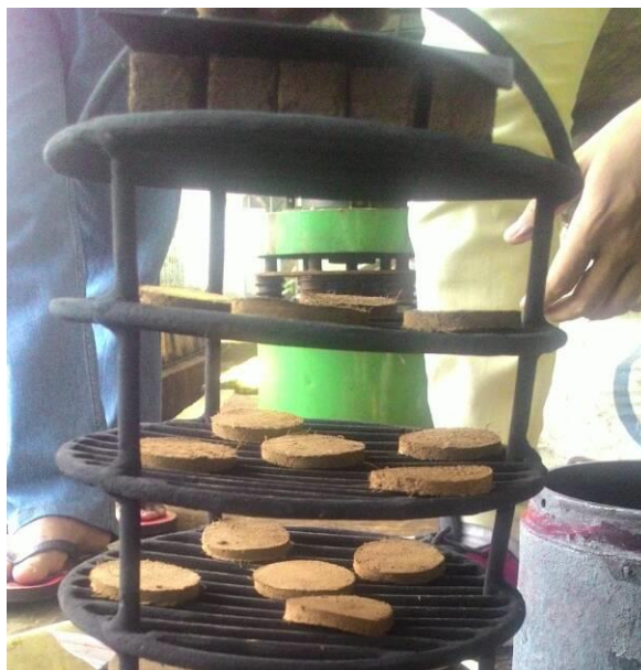
Gambar.4 Sample Ukuran Diameter 3 cm x 4 mm Sebelum Proses Karbonisasi
