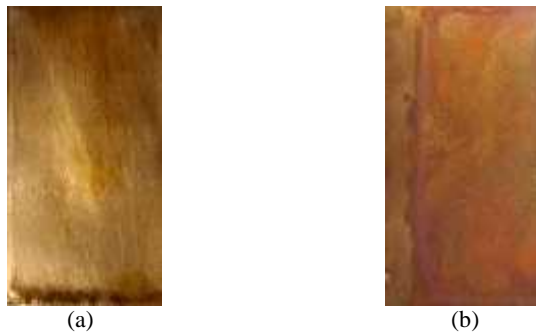
Gambar 9. Sampel plat tembaga (a) hasil salt spray (b)
