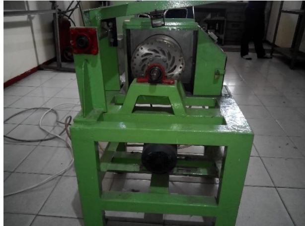
Gambar.5 Alat Uji Laju Aus untuk Sample Ukuran Diameter 4 cm x 1 cm
