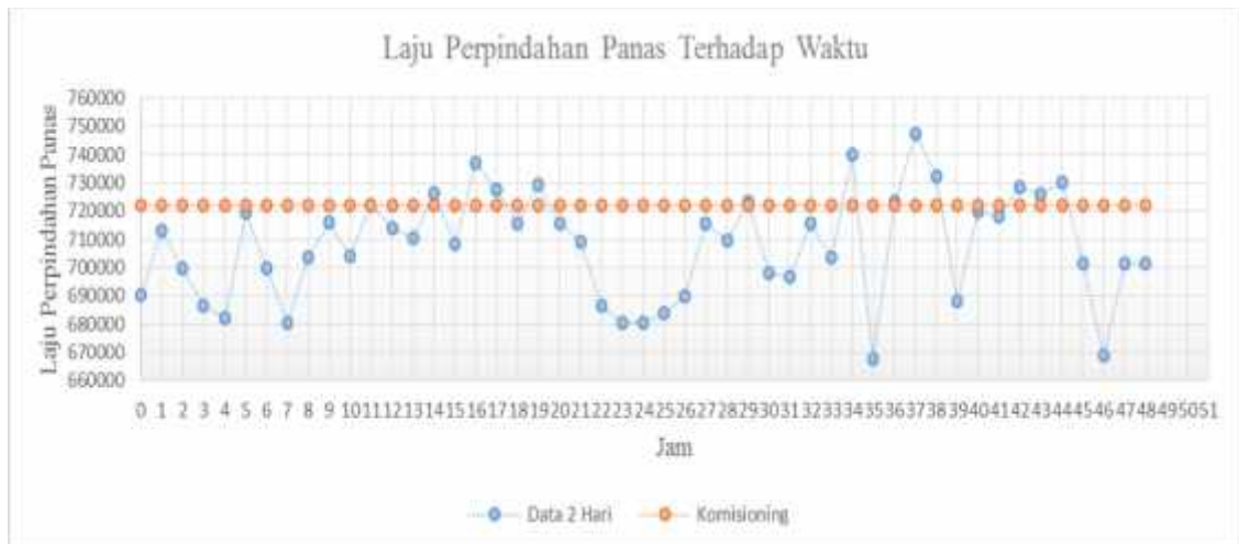
Gambar 4 Grafik Laju Perpindahan Panas Menara Pendingin
