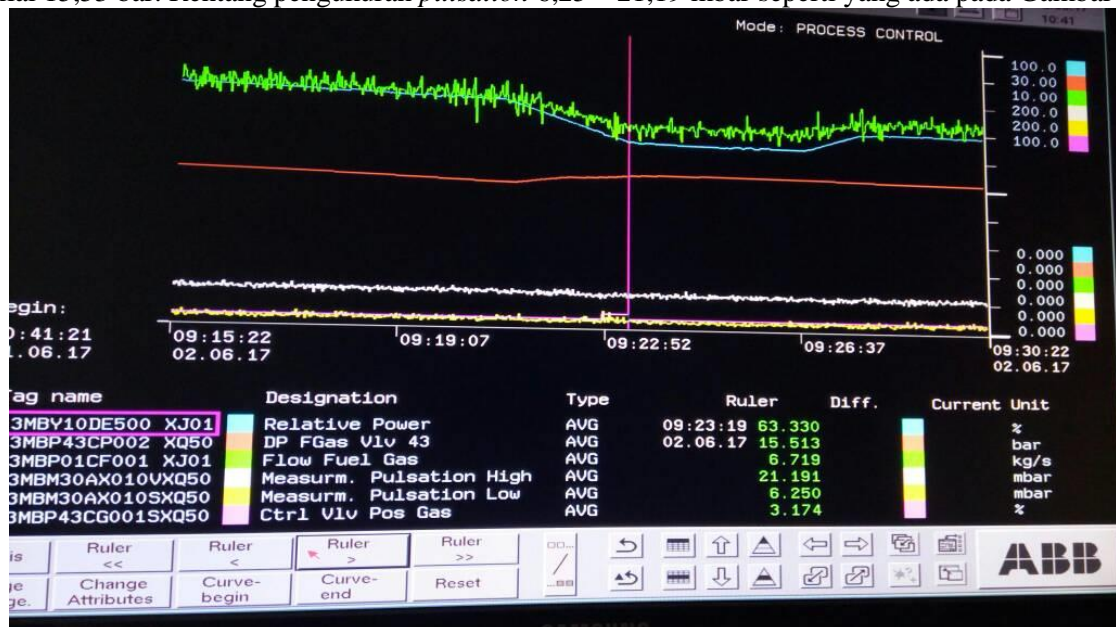
Gambar.6 Trending HMI Sesudah Prefilling
