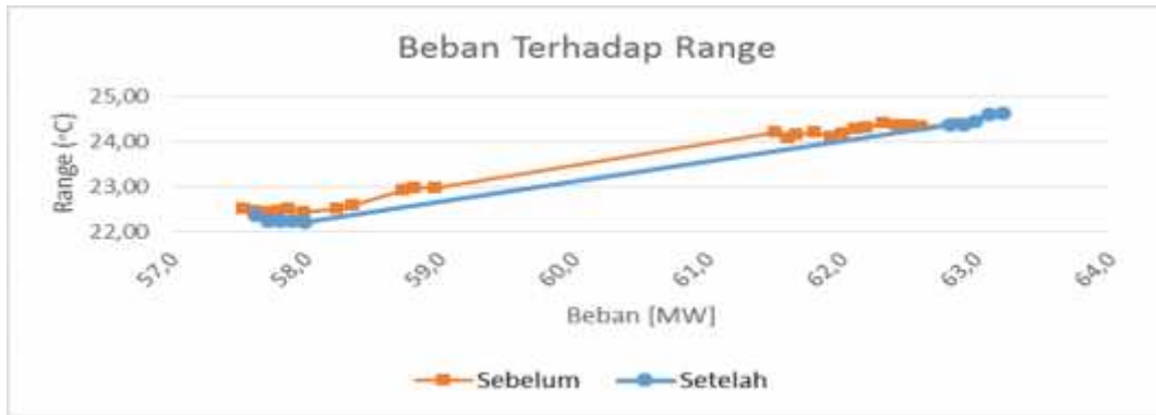
Gambar. 3.8 Grafik Beban Terhadap Range Sebelum Dan Setelah Overhaul
