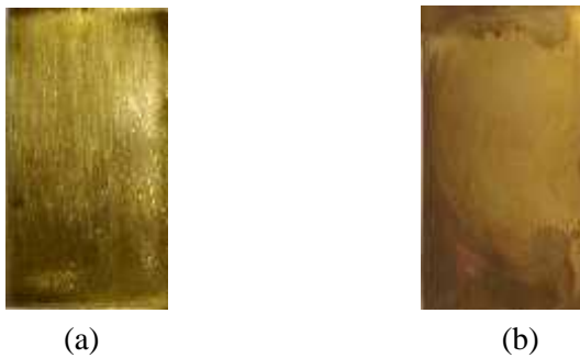
Gambar 8. Sampel plat kuningan (a) hasil salt spray (b)
