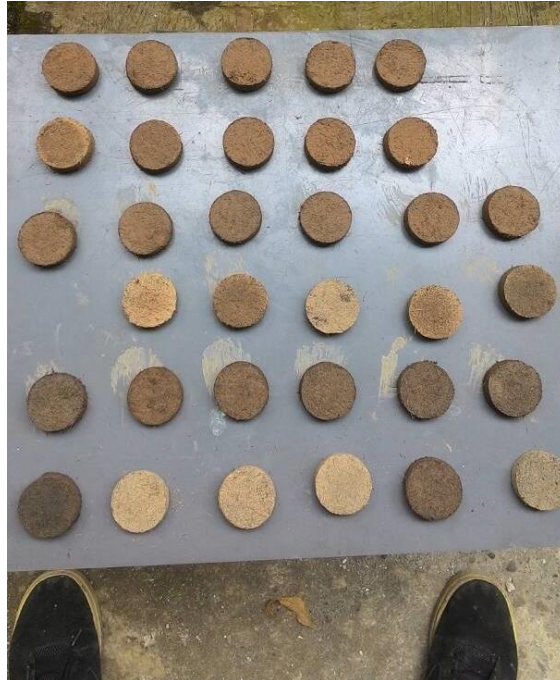
Gambar.3 Sample Ukuran Diameter 4 cm x 1 cm Sebelum Proses Karbonisasi
