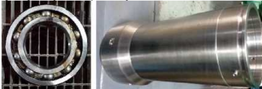
Gambar 3.11 Bearing dan Shaft Sleeve dalam kondisi baru
