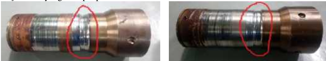
Gambar 3.9 Shaft Sleeve sisi bebas dan kopling
