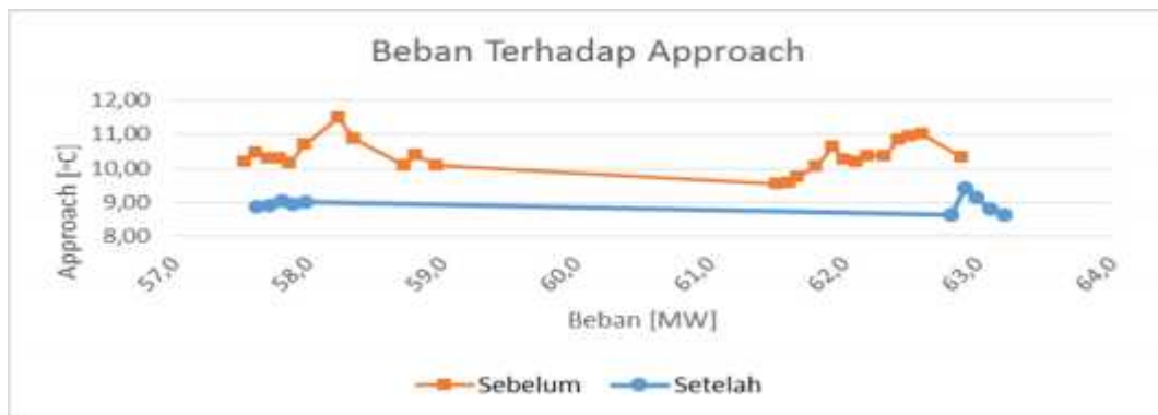
Gambar. 3.9 Grafik Beban Terhadap Approach Sebelum Dan Setelah Overhaul
