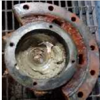
Gambar 3.9 Pelumas Bercampur Air pada Bearing Caps
