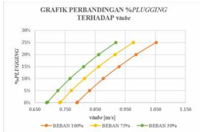
Gambar.3 Perbandingan Grafik Hubungan %Plugging Terhadap Kecepatan Air Pendingin ( V_{tube} )
