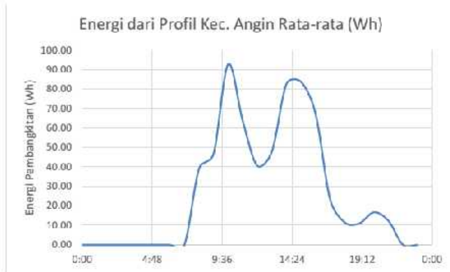
Grafik 4.5. Plot Pembangkitan Energi Turbin Angin dengan Profil Kecepatan Angin Rata – Rata
