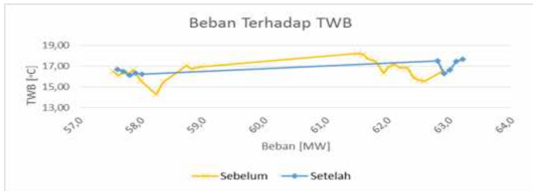
Gambar. 3.12 Grafik Beban Terhadap TWB Sebelum Dan Setelah Overhaul
